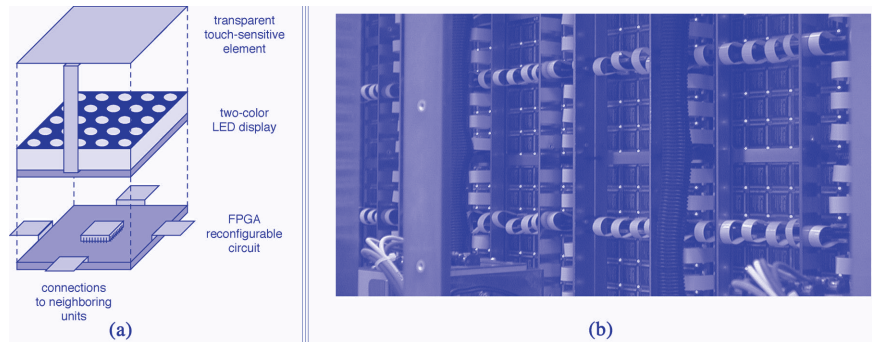
FIGURE 2 – (A) REPRÉSENTATION SCHEMATIQUE D'UNE UNITÉ DU BioWall, (b) VUE PARTIELLE DES CIRCUITS FPGA XILINX
