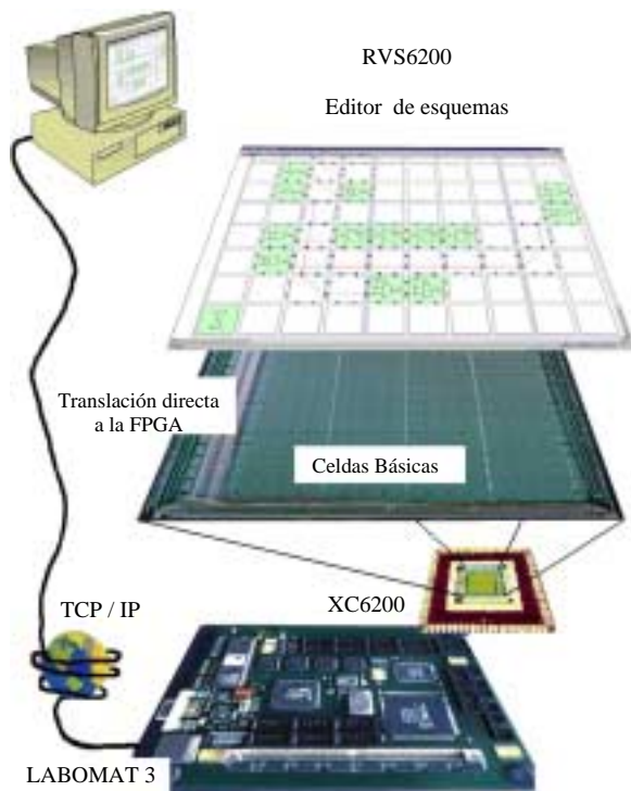
Figura 6: Diseño lógico, configuración y verificación simultánea en tiempo real
